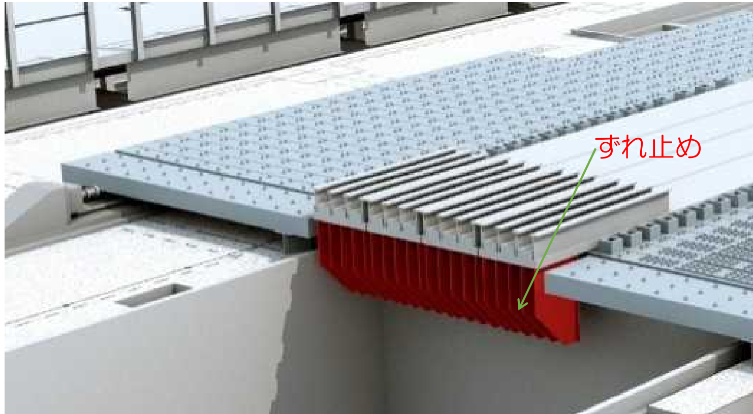
ずれ止め (A工区)
