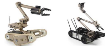
Kobra (左) Packbot (右) 主な役割 ・表面/空間線量率測定、表面汚染測定 ・調査助勢 等
