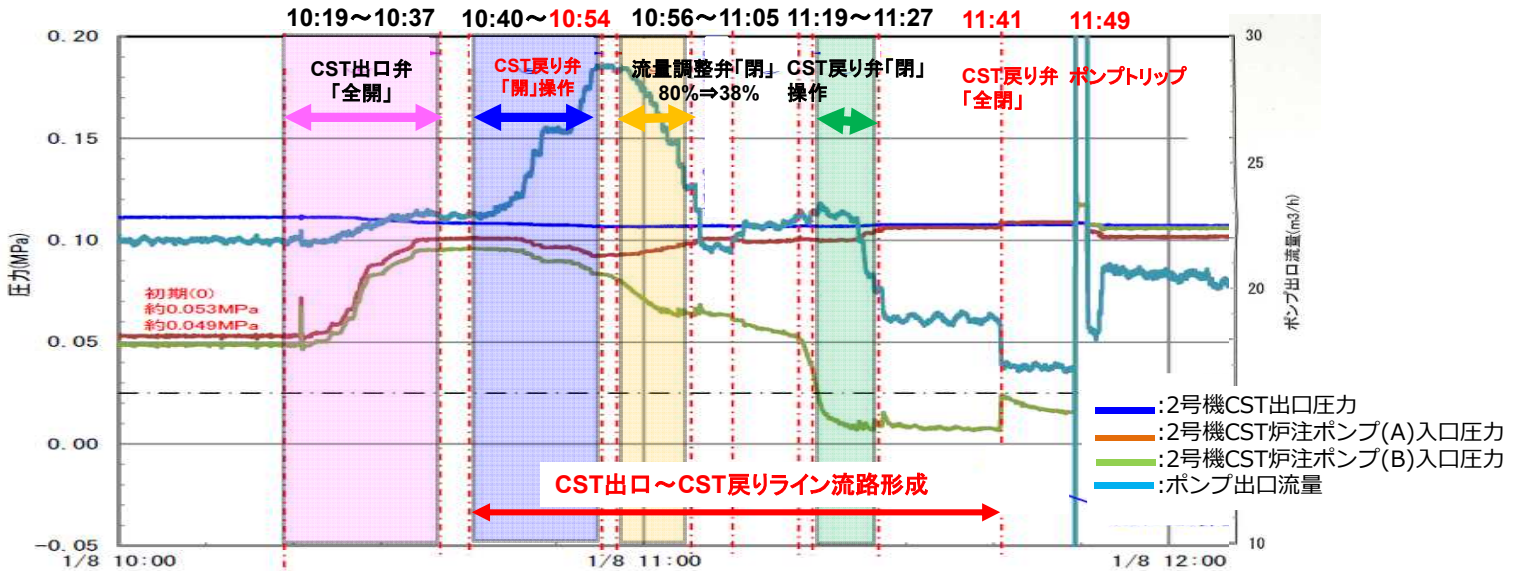
図-1 2号機 CST炉注ポンプトレンド
