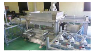
図4 遠隔交換HEPA 試験機
