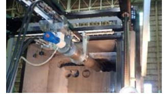
図2 生体避けい壁撤去要素試験
