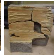
Fig 2 水深5mでの100mmジルコニアの切断
