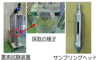
図3 セシウム吸着塔から使用済吸着材を採取するための採取試験装置とサンプリングヘッド
