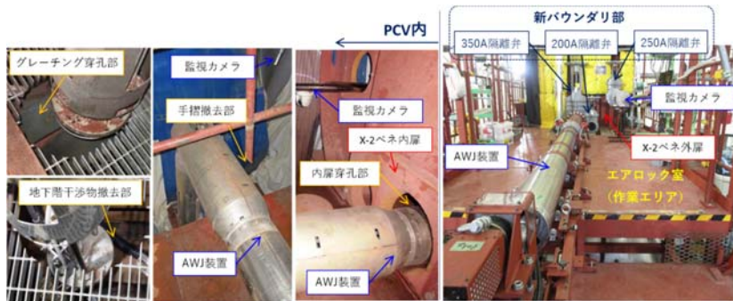
図1 アクセスルート構築のモックアップ試験状況
