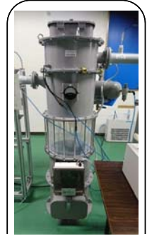
図3 気相前処理技術逆洗試験設備
